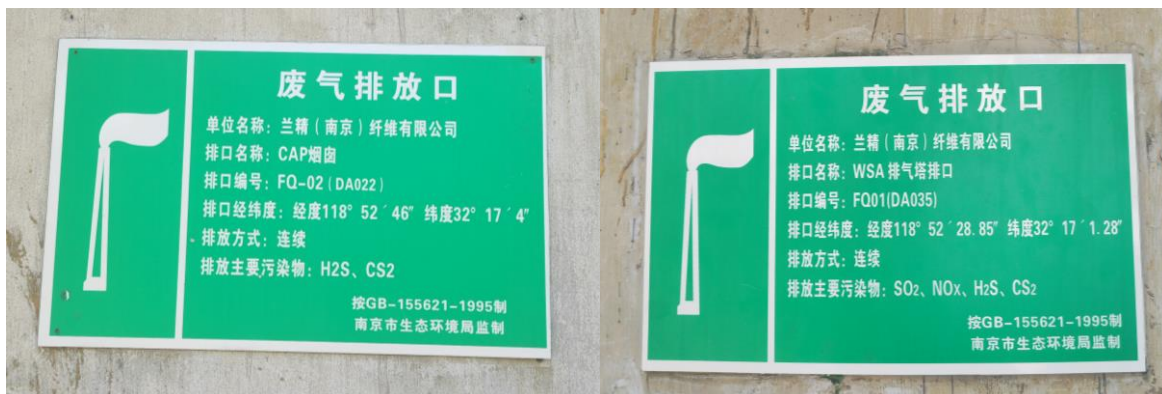
图 4.2-4 废气排口规范化标识牌
