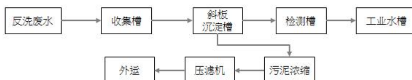
图 3.4-26 纯水反洗废水回收处理工艺流程
