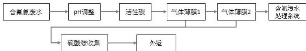
图3.4-20 含氟氨废水处理工艺流程
