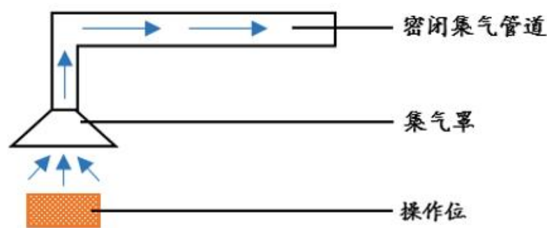
图 4-11 擦拭废气收集示意图
