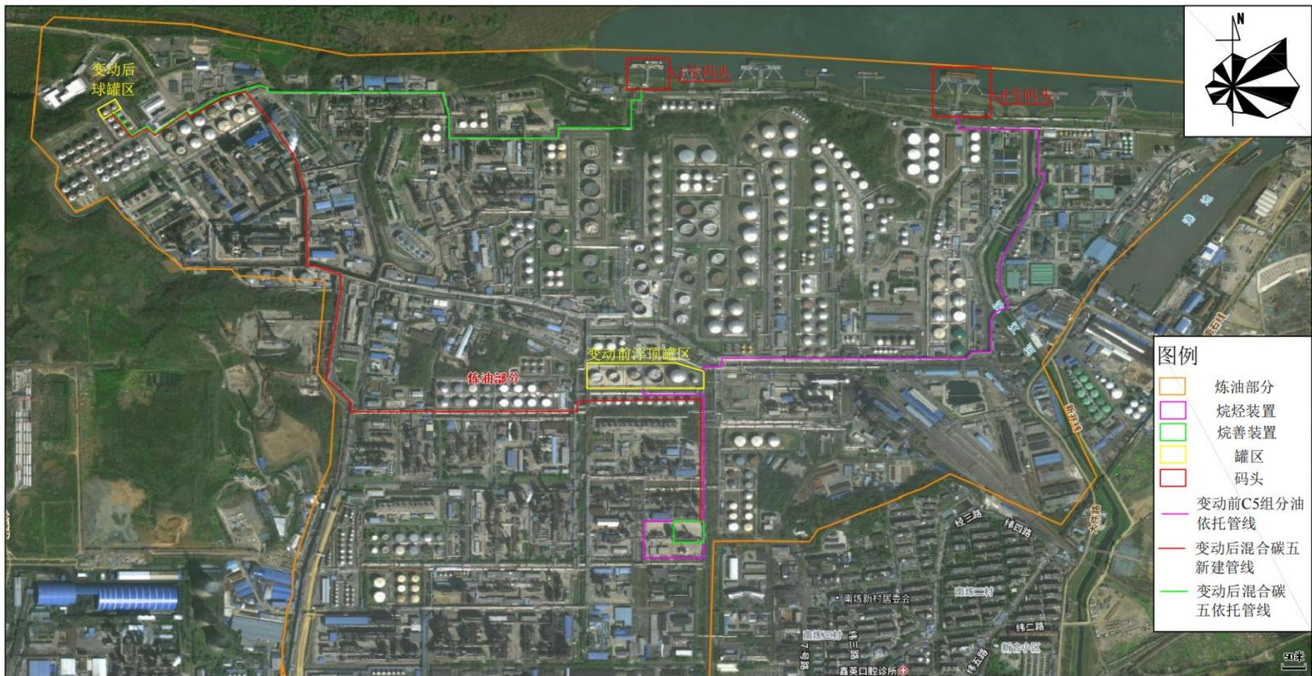
图 3.3-3 变动前后 C5 组分油、混合碳五管线路由图
