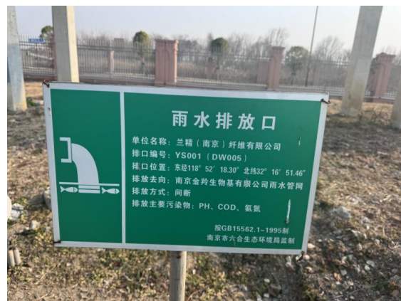
雨水排放口标识牌
