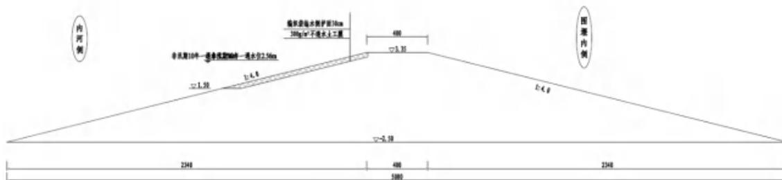
图 2-3 内河侧围堰断面图
