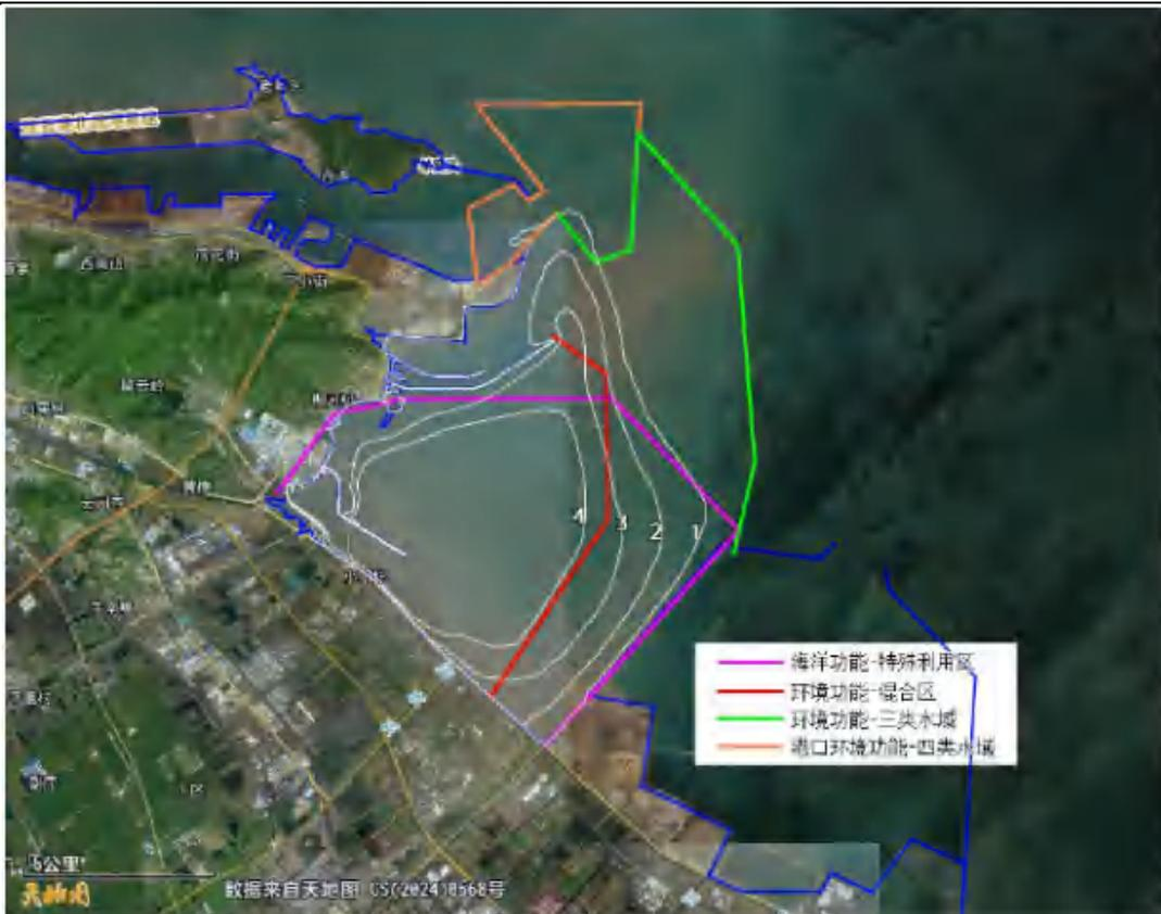
图 4-14 (1) 田湾核电站 1#~8#机组等温升线分布图 (大板跳闸流量  $159\text{m}^3/\text{s}$ )
